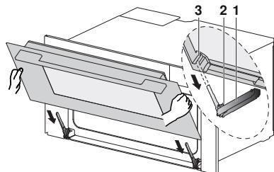
**⚠ Убедиться, что дверца прибора установлена до упора, в противном случае возможно повреждение прибора при закрывании дверцы.**
